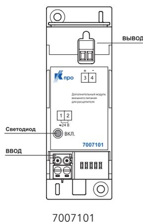
Устройство представляет собой преобразователь напряжения со входом  $\sim/ = 24, = 140-370, \sim 100-265\text{ В}$  (см. табл. характеристик ниже) и предназначено для использования с автоматическими выключателями серии «Протон» (в составе Электрон Про). Выходной ток преобразователя - до 250 мА, 1000 мА (см. табл. характеристик ниже). Зеленый светодиод указывает, что преобразователь включен и присутствует выходное напряжение.
